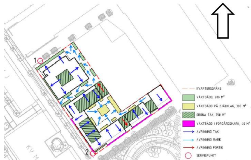
Illustration över föreslagen dagvattenhantering i kvarter H västra delen. Andreas Martin-Löf / Urbio / Structor.
