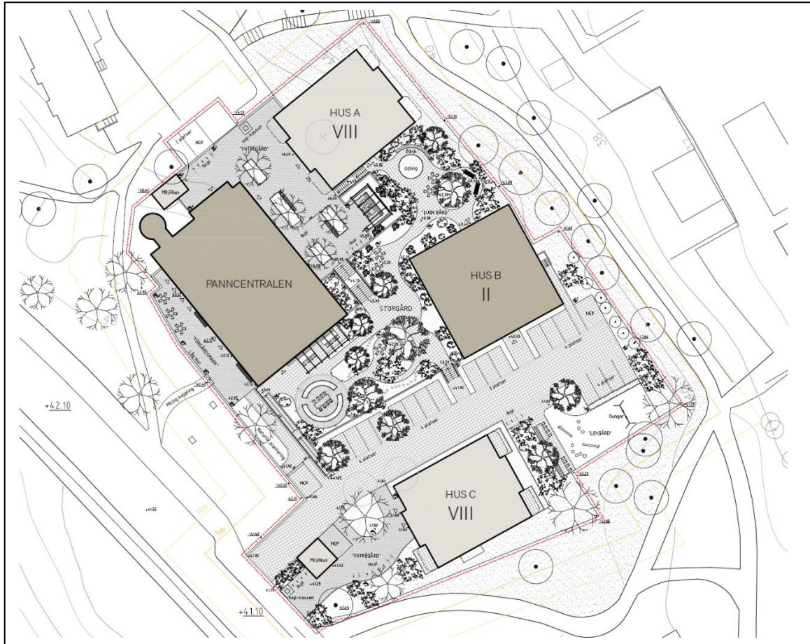
Figur 2. Situationsplan. Panncentralen och hus B är befintliga byggnader som ska byggas om till kontor respektive bostäder/kontor. Hus A och C är nybyggnation för bostadsändamål. Bild från Nyréns Arkitektkontor.
