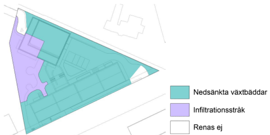
Uppskattade avrinningsområden till olika typer av dagvattenanläggningar. Illustration Starkstad 2025
