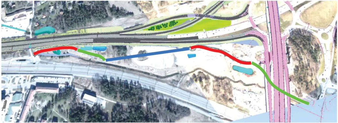
Figur 12 – GC-koppling mellan Hjulsta och Barkarby station. Grön: befintliga servicevägar, rött: planerade servicevägar och blått: saknad koppling
