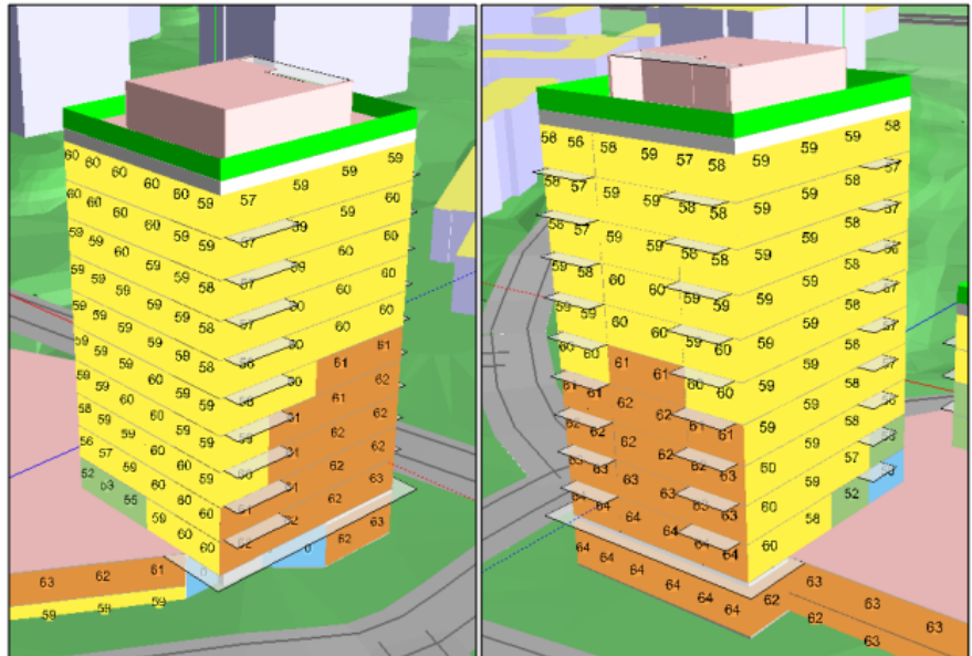
Dygnsekvivalent ljudnivå vid fasad för punkthus i kvarter Dansösen. Bild: Structor och Equator, 2025-11-18
