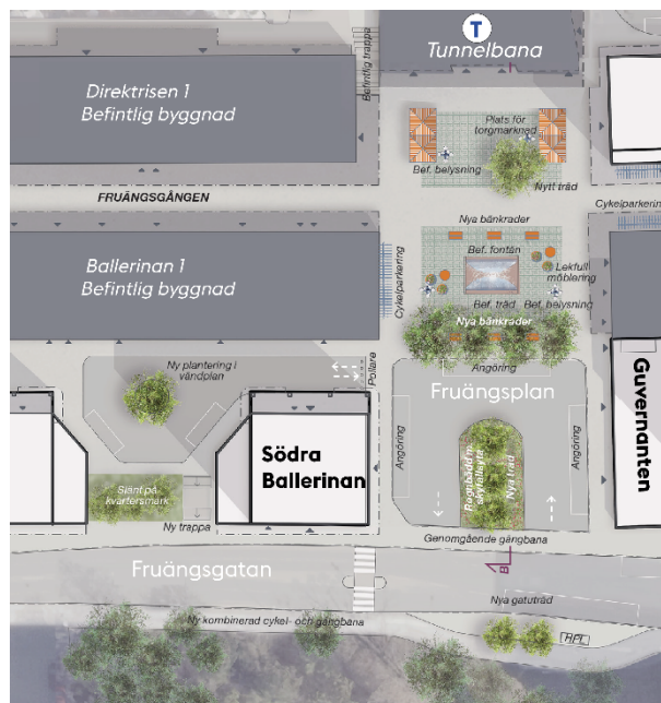
Situationsplan som visar utformning av allmän plats för Fruängsplan och Fruängsgatan. Bild Landskapslaget.
