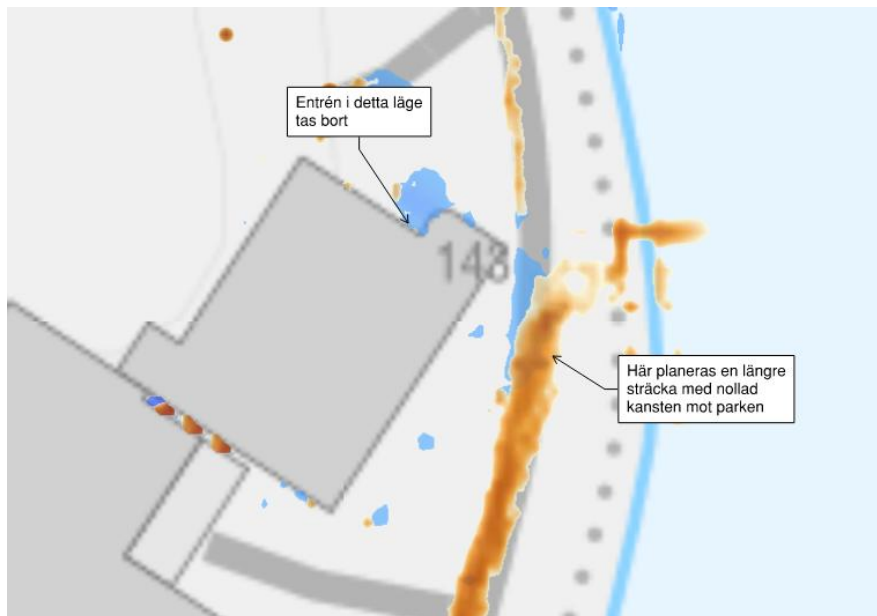
Figur 7-4. Maximala flöden och vattendjup som överskrider 10 cm i befintlig situation.
