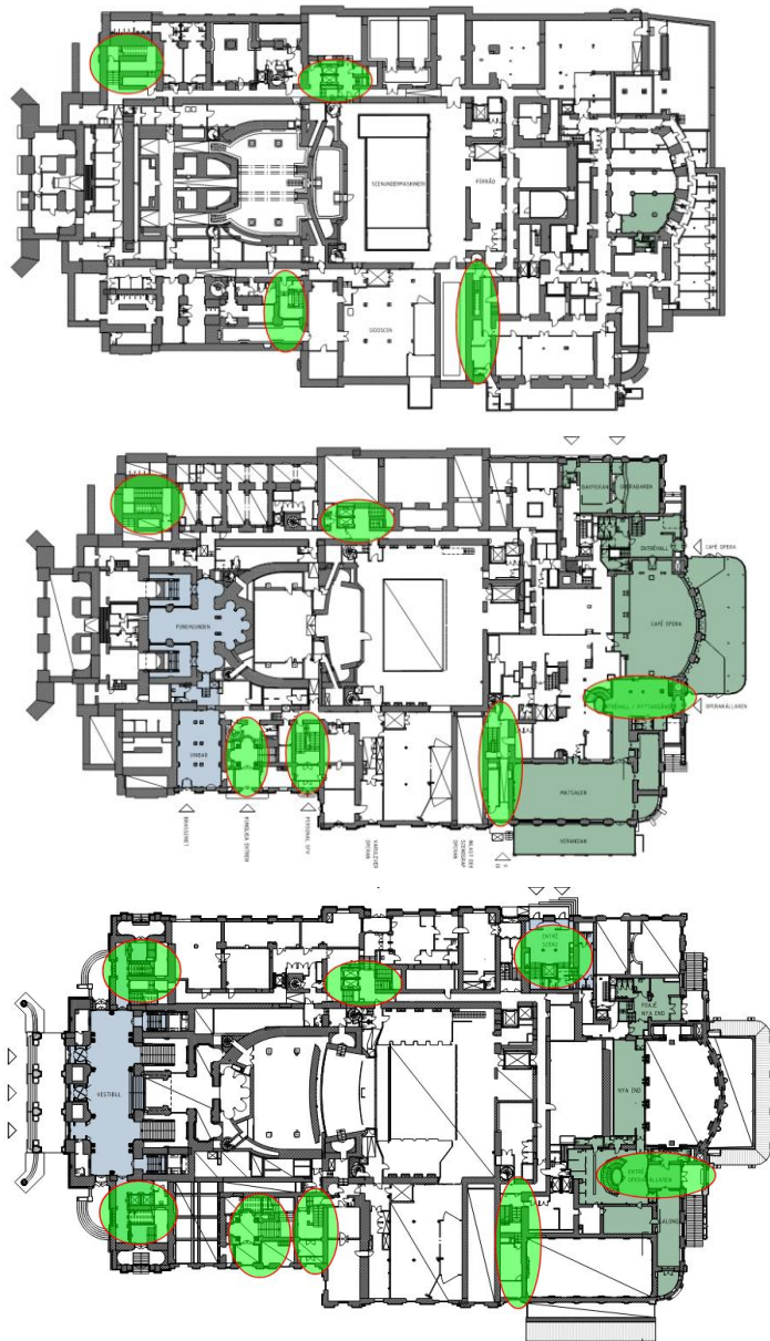
Figur 1. Principskisser utrymningsstrategi plan 01, 02 och 03. Gröna/röda cirklar markerar utrymningstrapphus. Blåa och gröna ytor är publika. För fullständig redovisning av utrymningspassager och utrymningsdörrar i plan 01-03, se Brandskyddslagets brandskyddsritningar och brandskyddsbeskrivning (avsnitt 5).
