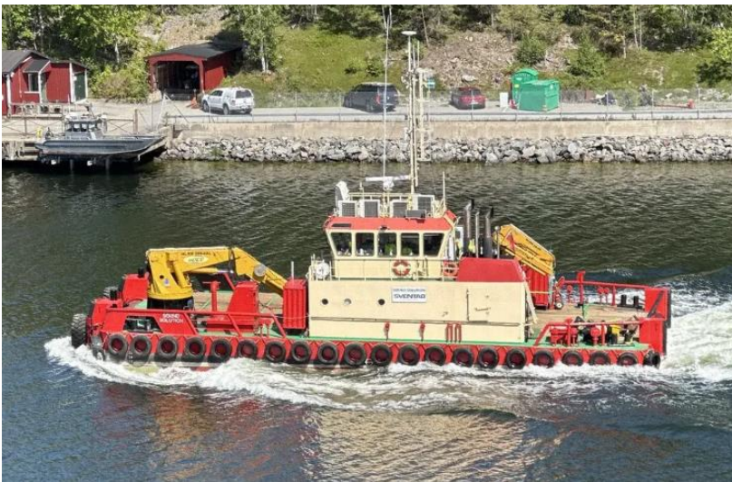
Figur 3-4. Bogserbåten Sound Solution, längd L 24,5 m, bredd B 9,9 m.
