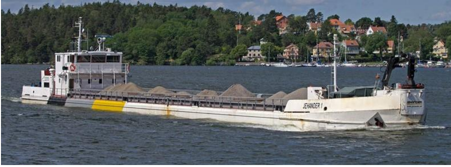
Figur 3-3. Fartyget Jehander 1 transporterar grus mellan täkter i Mälaren och hamnar i Stockholmsområdet. Kapaciteten är ca 1 400 ton per tur. Fartyget är byggt 1970 och har dimensionerna, längd L 75 m, bredd B 8,5 m och djupgående T 3,5 m.
