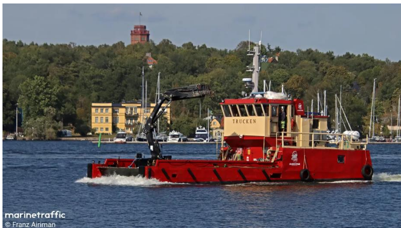
Figur 3-5. Bogserbåten Trucken, , längd L 18 m, bredd B 6 m.
