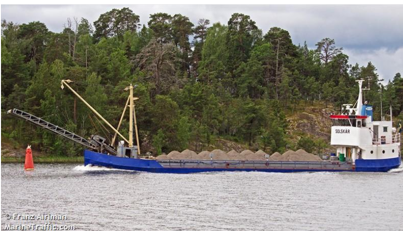
Figur 3-5. Solskär byggd 1946, längd L 33 m, bredd B 7 m.
