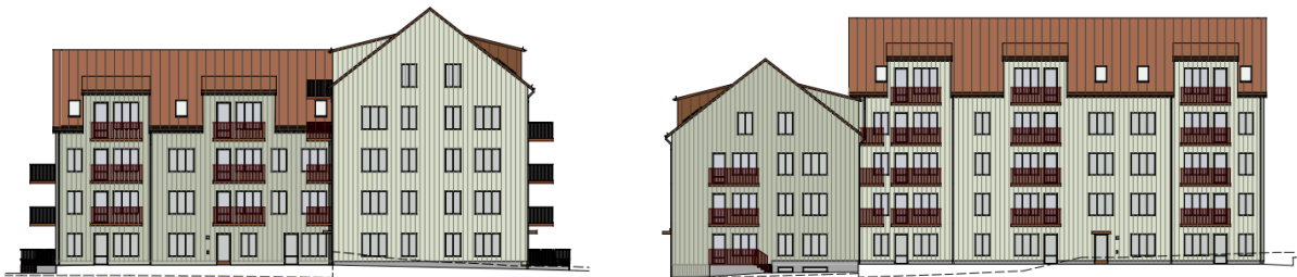
Fasadillustrationer av flerbostadshuset från gårdssidan. Fasad mot förskolan intill planområdet till vänster och fasad mot söder till höger. Mot innegård får frontespiser, balkonger samt terrasser finnas (Ettelva).
