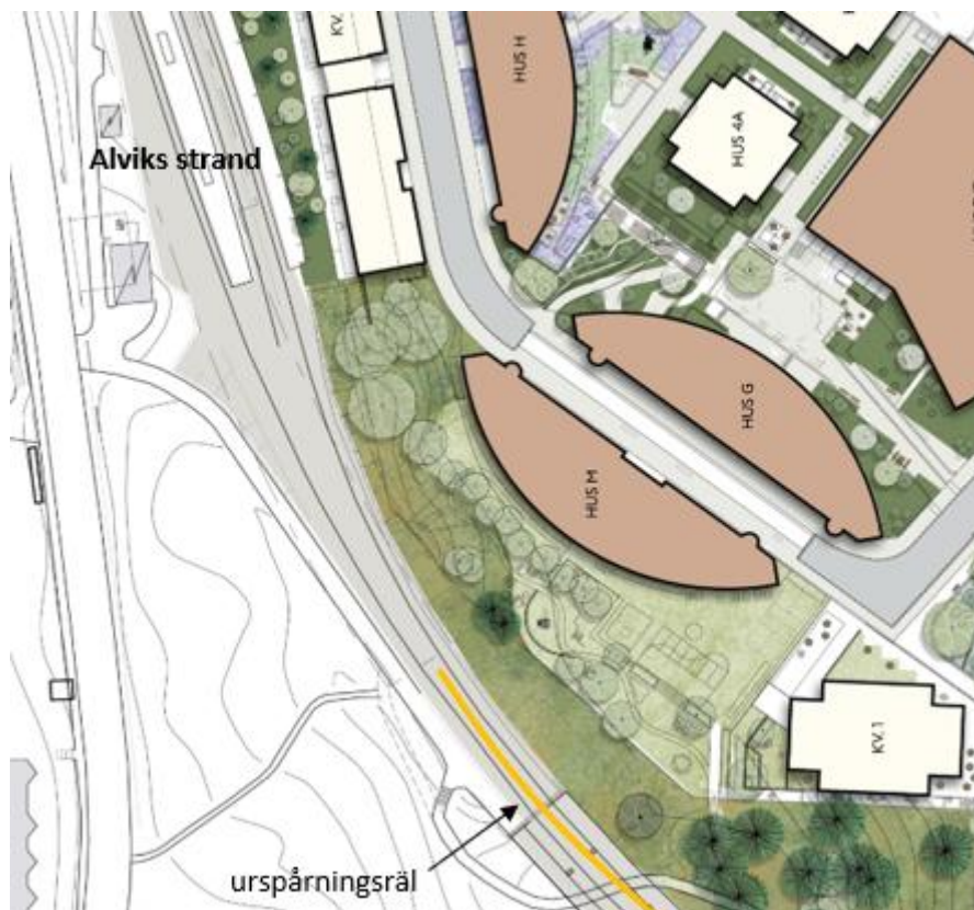
Figur 2. Aktuell del av Tvärbanan. Planområdet till höger om spåren. Placering av urspårningsräl är markerad med orange heldragen linje.
