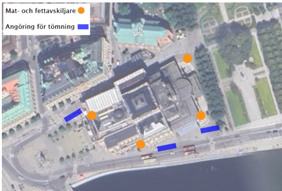
Placering av mat- och fettavskiljare i planförslaget samt angöring för tömning av dessa.
