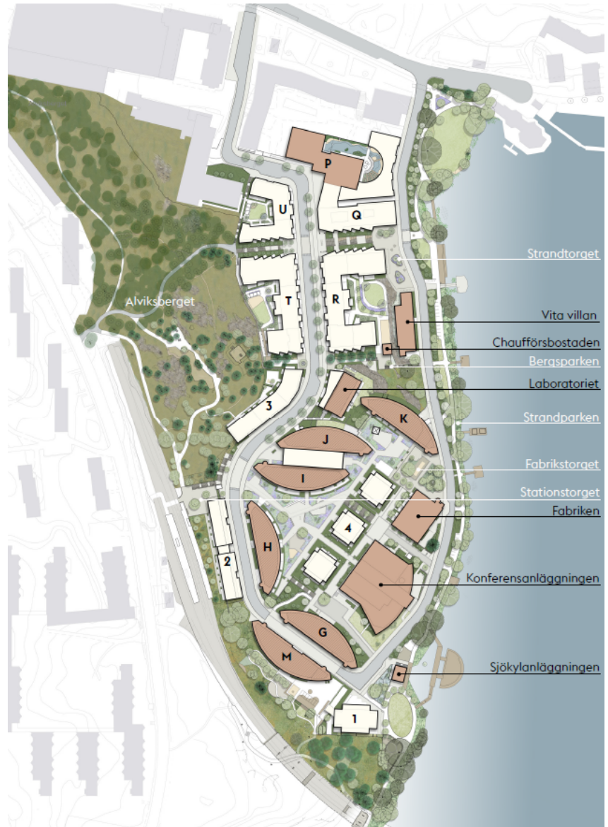
Illustrationsplan, brunt är befintlig bebyggelse, vit tillkommande (Ramboll)
