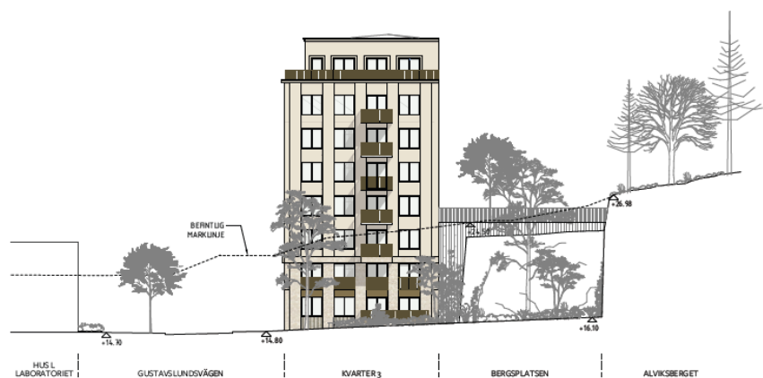
Elevation norra gaveln med gård ovanpå berg och mur mot Alviksberget (Brunnberg & Forshed Arkitektkontor)
