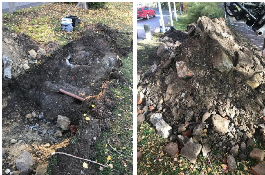
Figur 5. Exempel på fyllnadsmassor (provgrop 2w143) i norra del av strandlinje, med inslag av tegel, betong och järnskrot. Foton från (Wescon Miljökonsult, 2022c).
