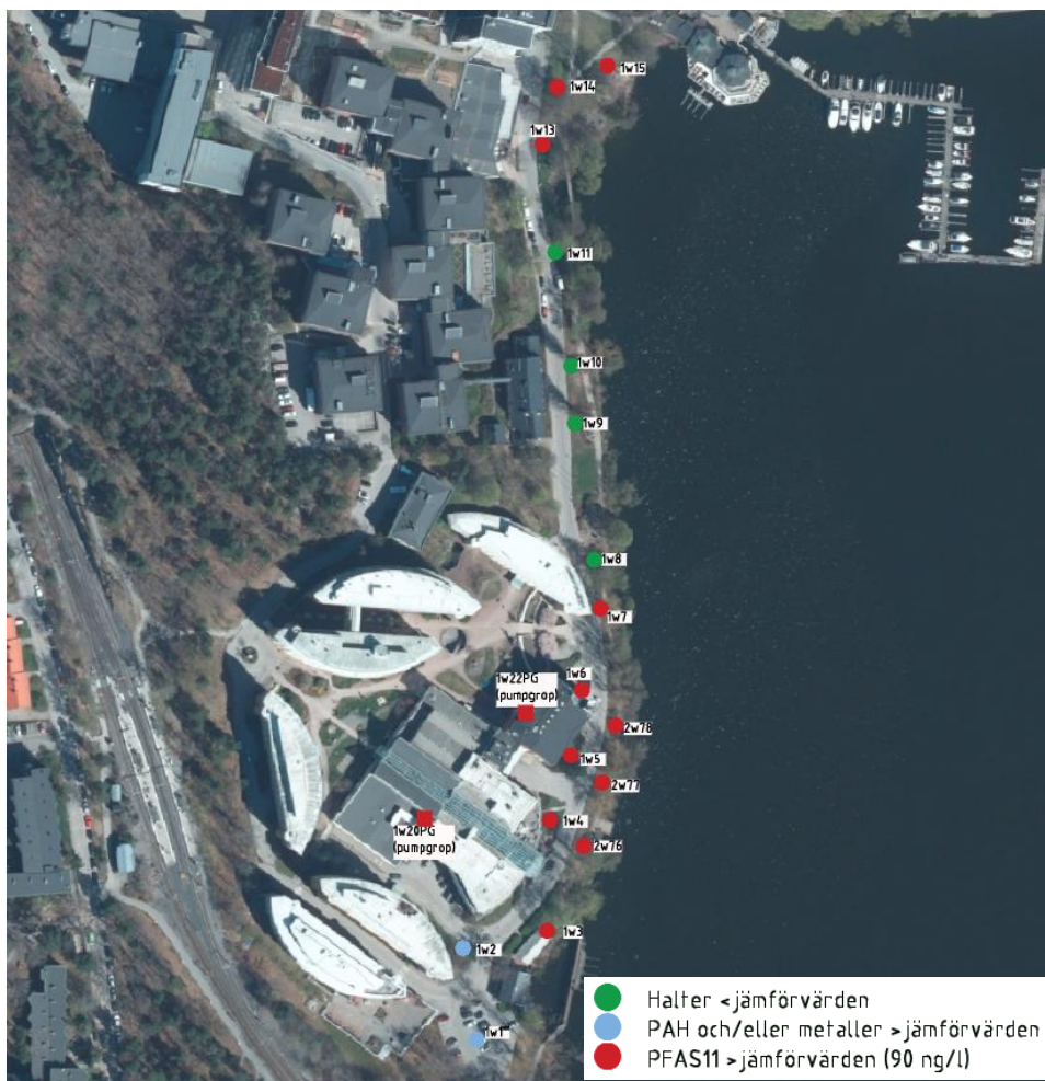
Figur 8. Grundvattenrör (cirklar) och pumpgropar (kvadrater) med föroreningshalter. I grundvattenrör 1w5, 1w6, 1w13, 1w15 överstigs förutom PFAS11 även PAH. Se i större format i Bilaga B.
