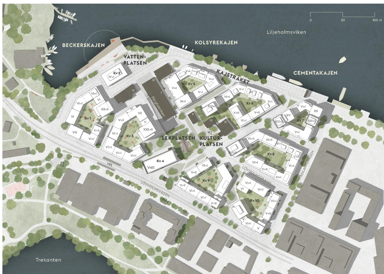
Illustrationsplan Lövholmen. Gråmarkerade byggnader är befintliga som bevaras, vita utgör nya kvarter, påbyggnad föreslås på Beckershuset (kv 4). Bild: FOJAB.
