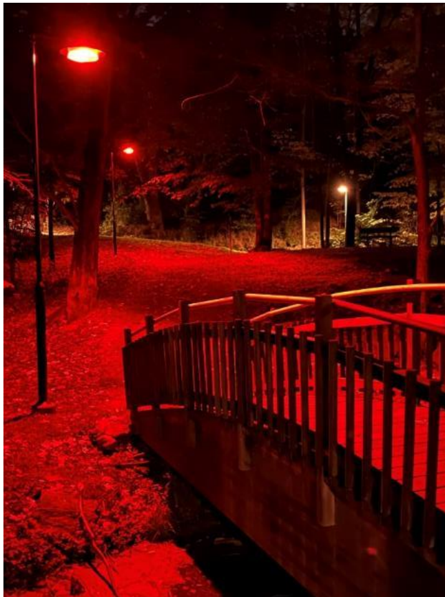
Foto: Med hjälp av närvarostyrning och färganpassning kan utomhusbelysningen ta hänsyn till flera fokusområden samtidigt. Exempel från Årstaskogens naturreservat. Foto: Mikael Ryberg.
