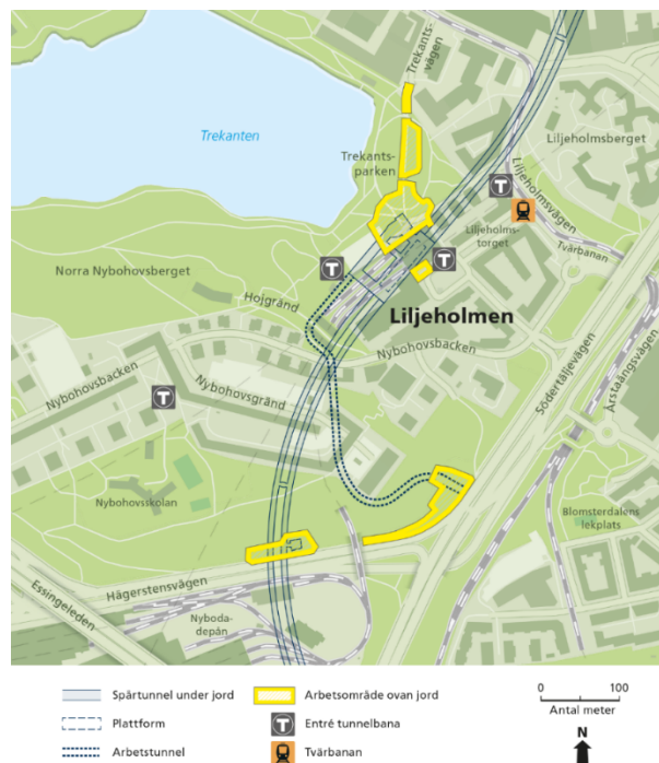
Bild 3: Arbetsområden, arbets- och servicetunnel vid Liljeholmen
