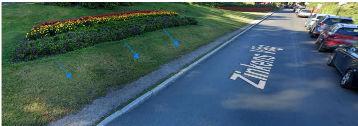
Figur 5-38. Visar att bräddning kommer ske från växtbädden längs markens lutning ut i Zinkens väg.
