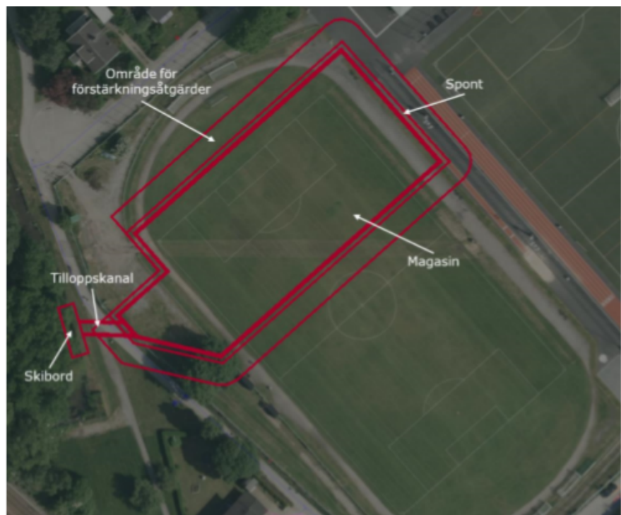
Figur 1: Illustration över magasinets placering under naturgräsplanen. (Bild från samrådshandlingarna)
