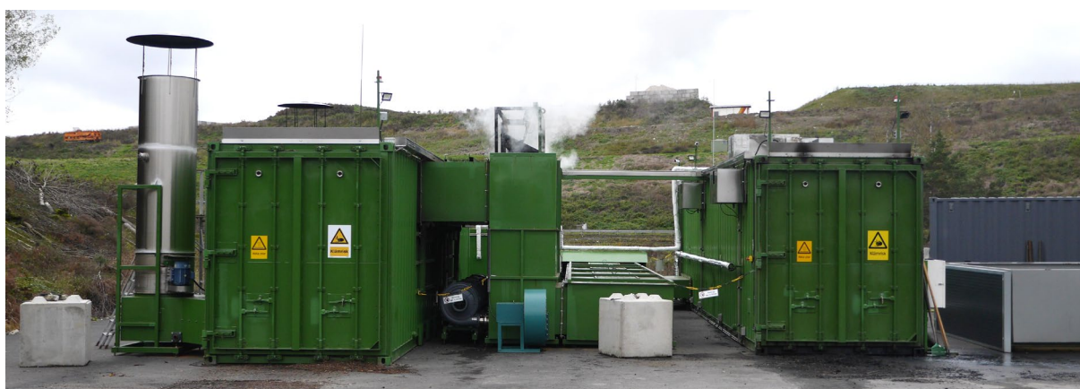
FIGUR 16 TELGE ÅTERTVINNING BIKOLPANNA OCH TORK (FOTO: EcoTOPIC).
