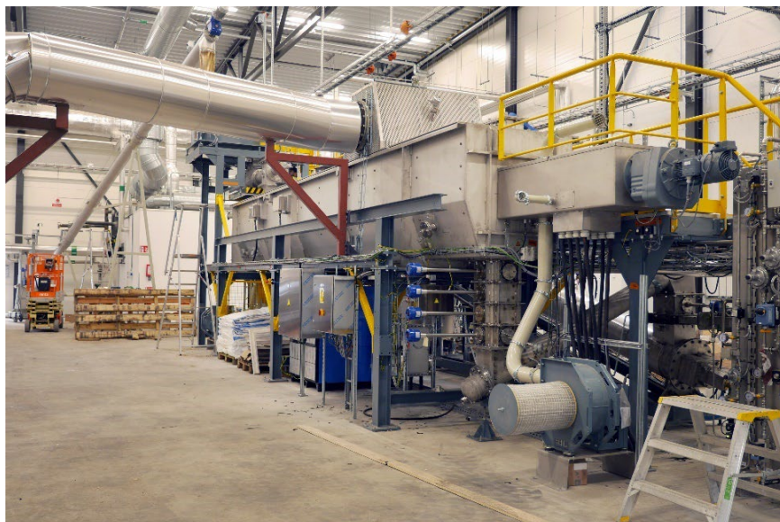
FIGUR 17 NSR:S BIKOLPANNA FRÅN BIOGREEN (FOTO: ECOTOPIC).
