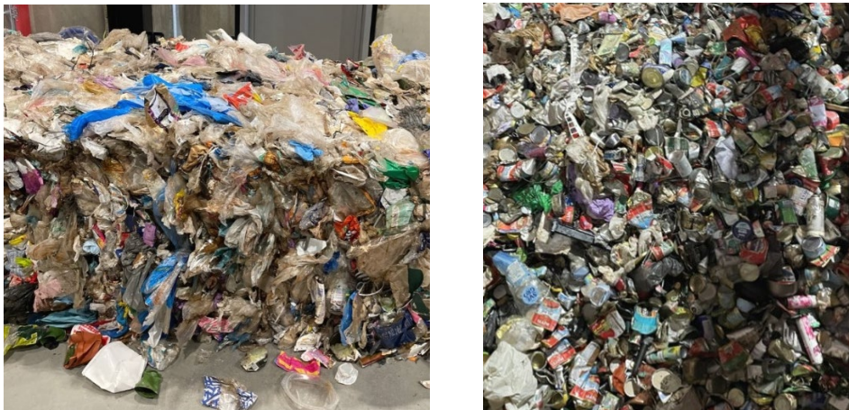
Figur 7. Bilden till vänster visar hur den utsorterade plastfraktionen ser ut. Bilden till höger visar utsorterad metall.
