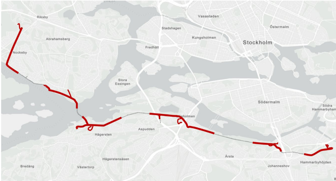
Figur 8 Kartbild över avloppstunnelns sträckning. Utsprängda delar markerade.
