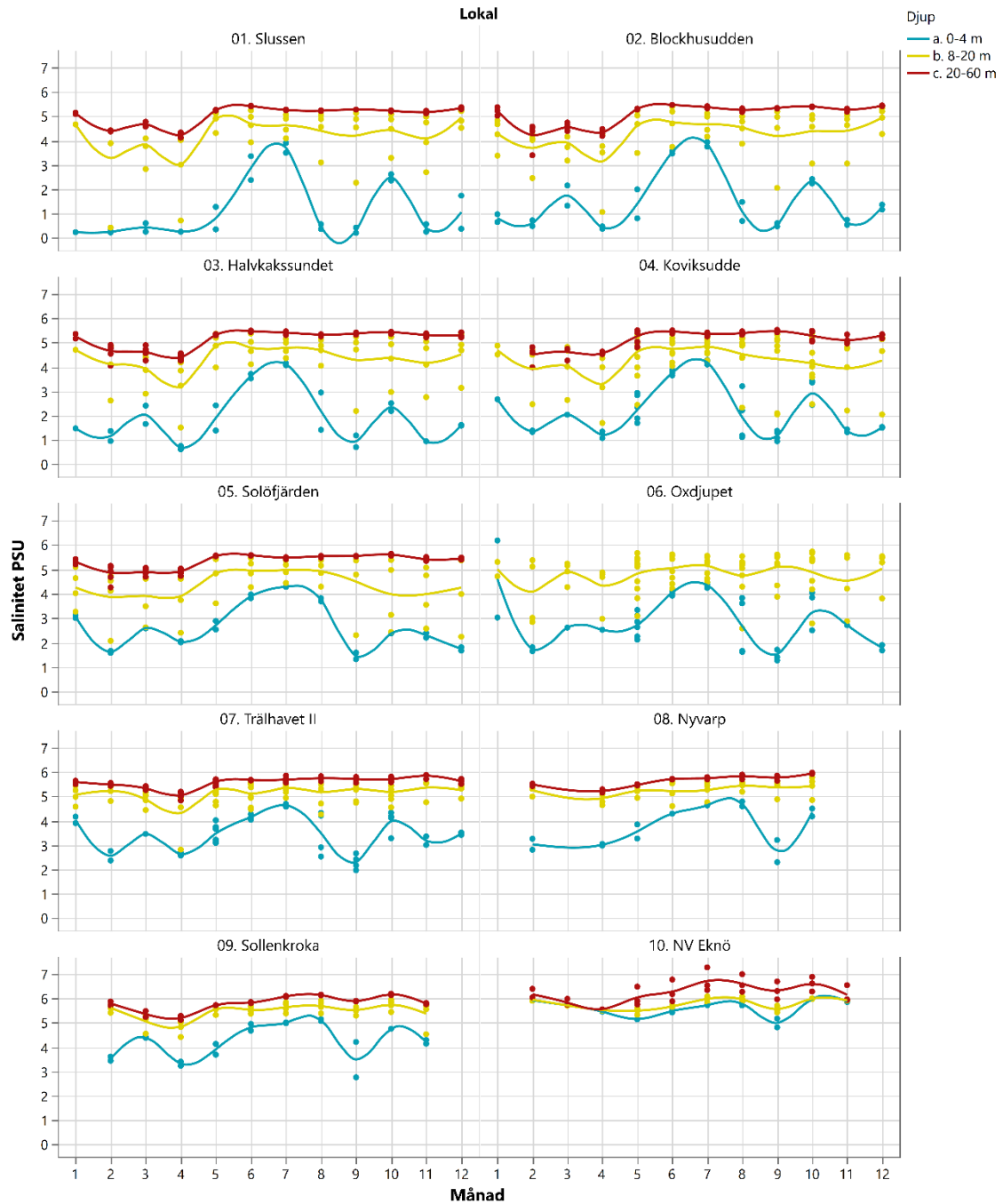
Figur 14. Variation av saliniteten i ytvattnet (0–4 m; blå), en bit ner (8–20 m; gul), och i bottenvattnet (20–60 m; röd) under året 2023 längs med segelleden. Linjerna anger medelvärden, och prickarna visar de faktiska analysresultaten.
