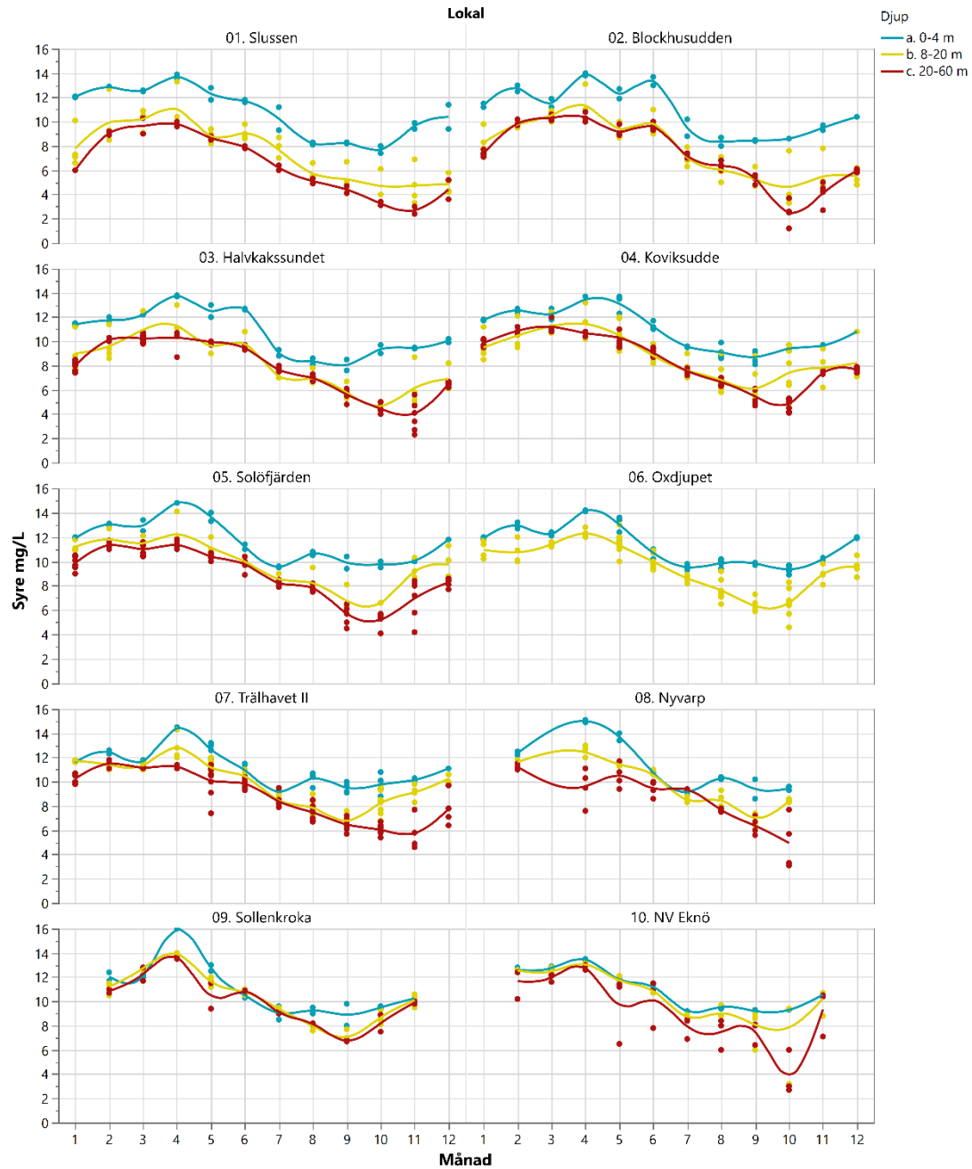
Figur 19. Variation av syrehalten i ytvattnet (0–4 m; blå), en bit ner (8–20 m; gul), och i bottenvattnet (20–60 m; röd) under året 2023 längs med segelleden. Linjerna anger medelvärden, och prickarna visar de faktiska analysresultaten.
