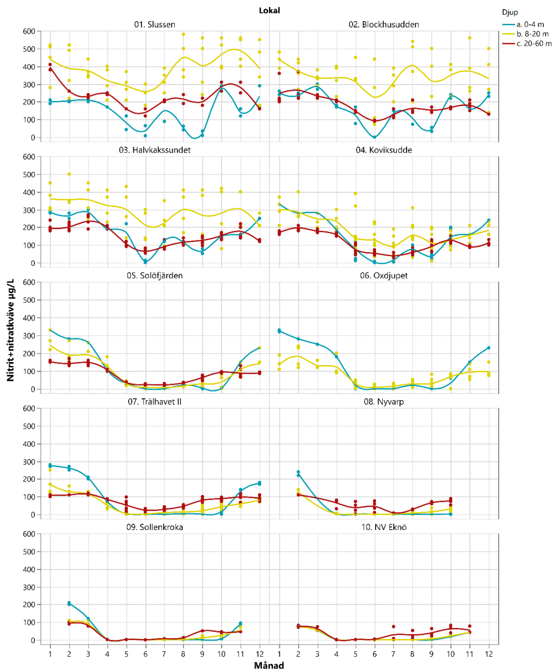
Figur 29. Variation av nitrit+nitratvävehalten i ytvattnet (0–4 m; blå), en bit ner (8–20 m; gul), och i bottenvattnet (20–60 m; röd) under året 2023 längs med segelleden. Linjerna anger medelvärden, och prickarna visar de faktiska analysresultaten.
