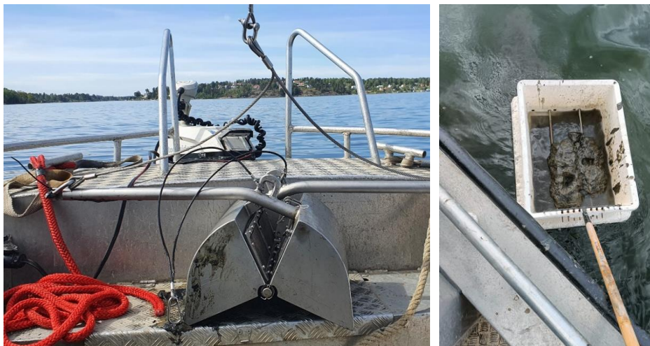
Figur 3. Till vänster: van Veen huggaren som användes vid provtagningen. Till höger: Sällning av prover med hjälp av ett flytsåll.
