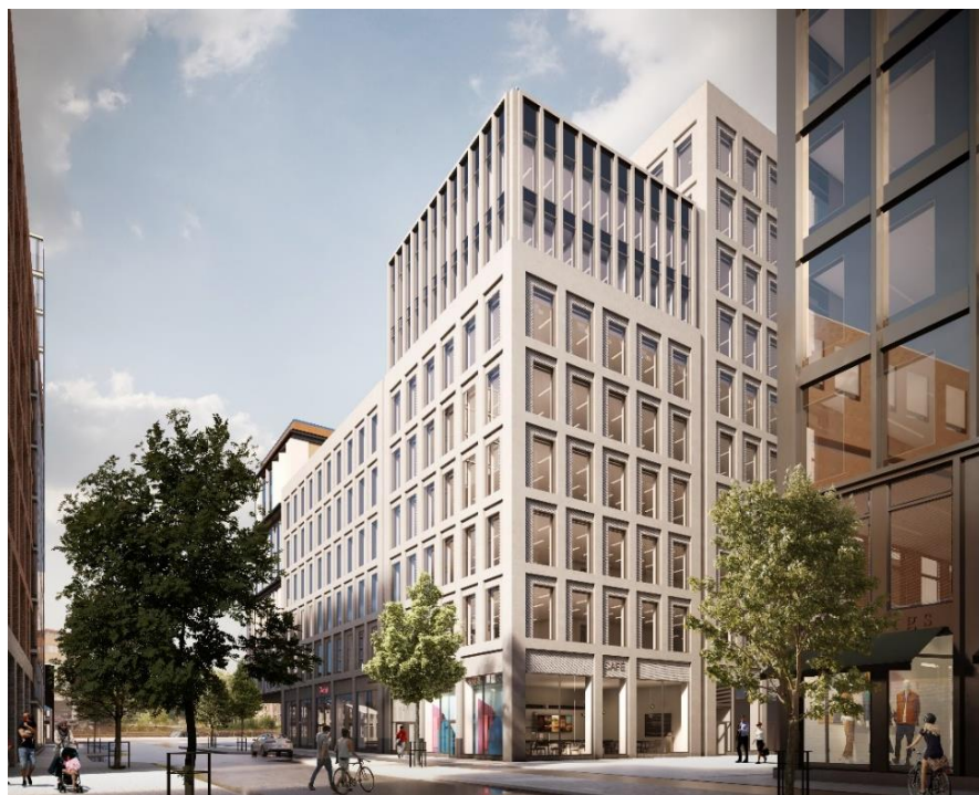
Vy mot väster längst Hangövägen. Byggnad i kvarteret Hangö, A2 på plankartan. Bilden visar hur hörnets övre våningar skiljer sig i utformning för att tydliggöra gatans sexvåningsskala enligt med planbestämmelse f1. Illustration Brunnberg Forshed.
