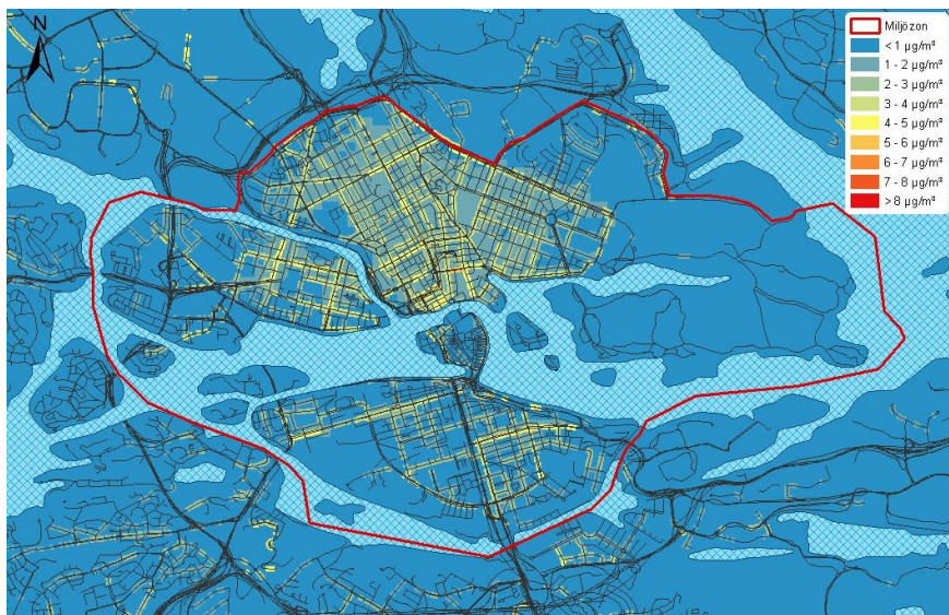
Figur 26: NO 2 -dygnshalter, skillnad 2022 mellan scenario med 2017 års andel fordon som bryter mot miljözon klass 1 och full efterlevnad av denna miljözon.
