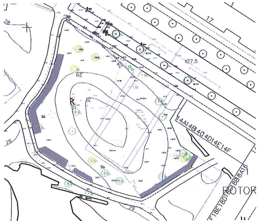
Illustration över planområdet med föreslaget dike längs fastighetsgränsen markerat i grå färg. Illustration WSP.
